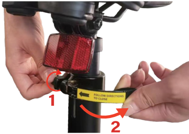
15. Plaats de zadelpen in de zitbuis. Let op: Zet de zadelpen niet zo hoog dat de minimummarkering op de zitbuis zichtbaar wordt. Draai de knop op de zadelpenklem tot de juiste spanning en druk vervolgens op de hendel om deze te vergrendelen.
