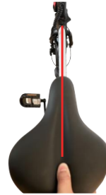
16. Voordat u gaat rijden, moet u controleren of de zadelkop in één lijn ligt met het frame en of het zadel los zit.
