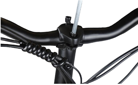
13. Vergrendel de schroef van de snelontgrendeling van de handgreep.
