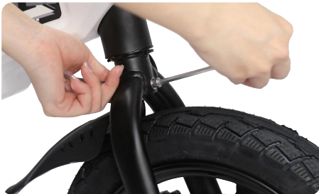
17. Installeer het voorspatbord.
