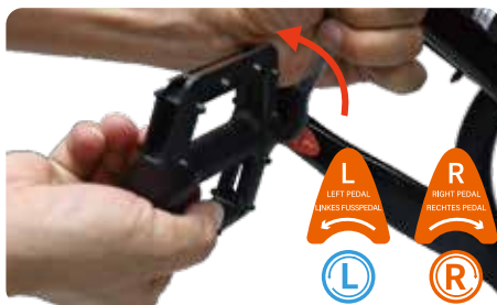
12. Busque el eje del pedal y el pedal marcado con la letra correspondiente y apriete la tuerca en la dirección indicada por el eje del pedal.
