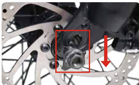
10. Alinee la abertura en la parte inferior de la horquilla delantera con el tornillo de la rueda delantera y encaje en su lugar.
