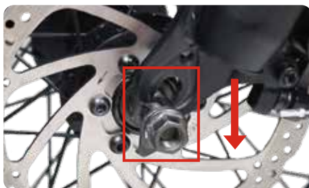
10. Alignez l'ouverture au bas de la fourche avant avec la vis de la roue avant et enclenchez-la.
