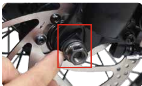
11. Inserire il gancio di sicurezza della vite della ruota anteriore nella fibbia di sicurezza, quindi bloccare i dadi su entrambi i lati.
