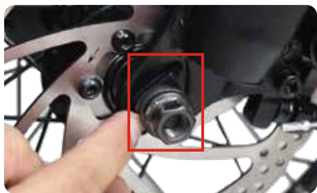
11. Inserte el gancho de seguridad del tornillo de la rueda delantera en la hebilla de seguridad y luego bloquee las tuercas en ambos lados.
