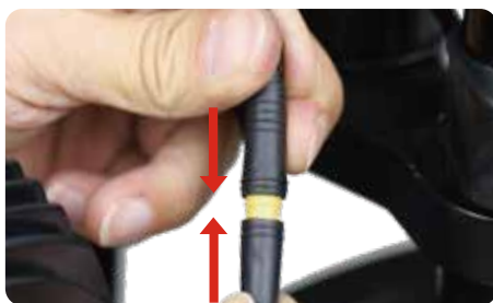
8. Allineare l'interfaccia del faro combinato secondo la freccia indicata.
