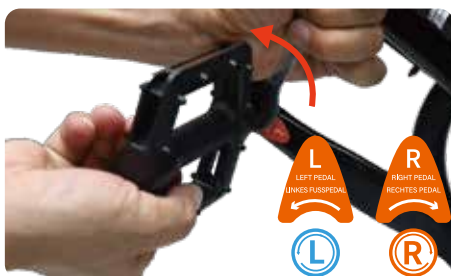
12. Trova l'albero del pedale e il pedale contrassegnati con la lettera corrispondente e serra il dado nella direzione indicata dall'albero del pedale.
