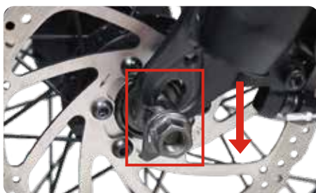
10. Allineare l'apertura sul fondo della forcella anteriore con la vite della ruota anteriore e farla scattare in posizione.
