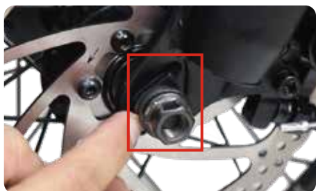
11. Insérez le crochet de sécurité de la vis de roue avant dans la boucle de sécurité, puis bloquez les écrous des deux côtés.
