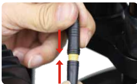
8. Alinee la interfaz del faro combinado según la flecha indicada.
