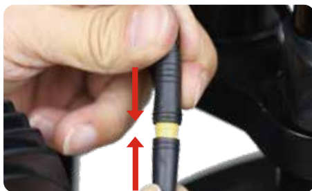
8. Alignez l'interface de phare combiné selon la flèche indiquée.
